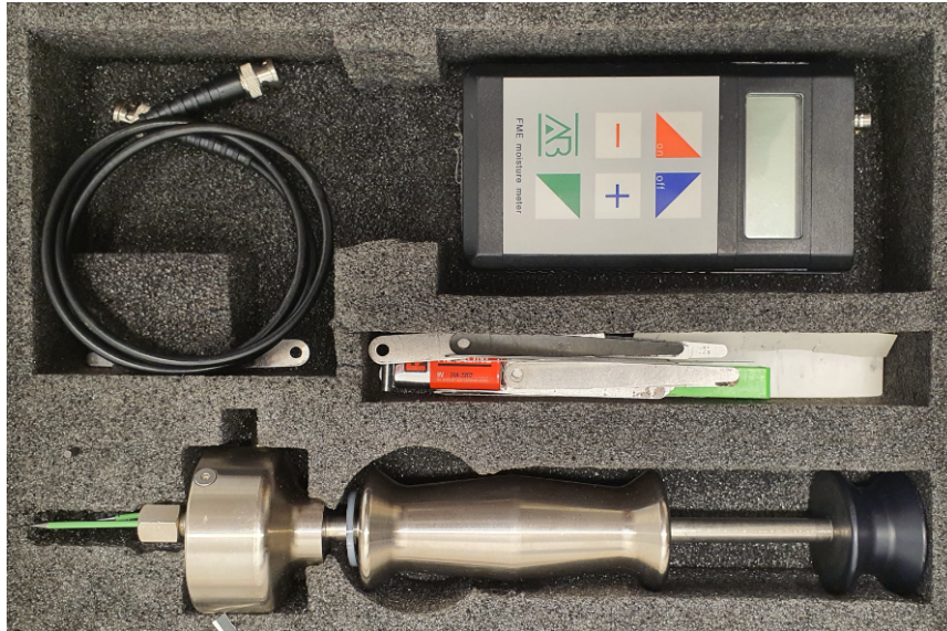
Figur 3: Eksempel på elektrisk motstandsmåler for fuktmåling i tre (Foto: Jørn Emil Gaarder, SINTEF)
